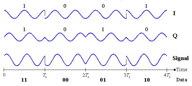
2 bits per symbol, ~ 1bit/s/Hz
